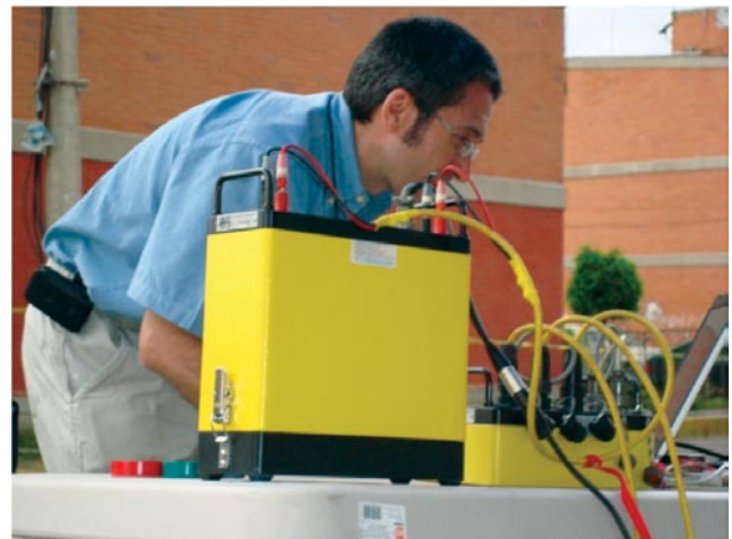
En la logística de campo se adquirieron cinco perfiles con una distancia media entre electrodos de 5 metros
