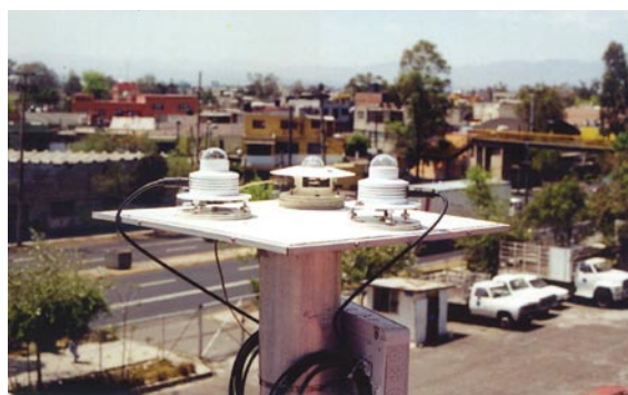
Estación de Radiación Solar Global, Radiación Solar Ultravioleta Banda "A" y "B", de la Secretaría del Medio Ambiente del Gobierno del D.F., instalada por el ORS
