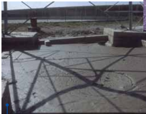
Volcán de lodo ocasionado por la licuefacción del terreno.
